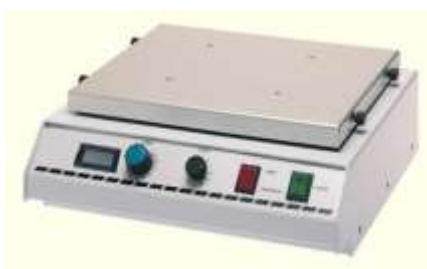
① Agitateur horizontal Moteur à induction Amplitude : 10 mm Vitesse variable : 100 à 500 rpm Minuterie digitale 0 à 120 minutes Protection IP30 Surface du plateau : 340 x 290 mm Dimensions : 375 x 375 x 145 mm Poids : 18 kg
