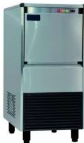
③ Ice Compact 40 kg Capacité : 40 kg/24h Bac de stockage de 14 kg Carrosserie entièrement en inox 18/8 Condensateur surdimensionné adapté aux climats chauds Réglage du contenu en eau des paillettes Fonctionnement robuste sans électronique Dimensions : 405 x 750 x 515 mm Poids : 36 kg
