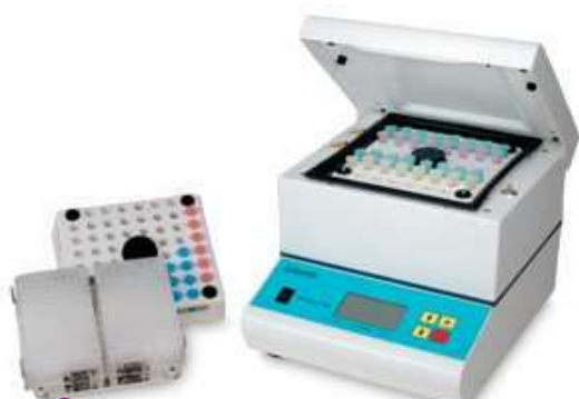
① Incubateur agitateur pour microtubes Capacité : 56 x 1,5/2 mL ou 4 microplaques Vitesse variable : 20 à 1300 rpm Orbite : 3 mm Plage de température : Ambiante+5°C à 100°C Régulation par microprocesseur programmable (T° et vitesse) Minuterie 1 à 999 minutes Alarme sonore et visuelle Dimensions : 265 x 245 x 222 mm Poids : 11 kg
