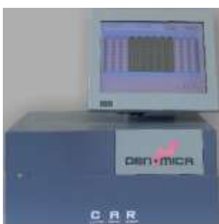
① CLART Clinical Array Reader Utilisable pour tubes et barrettes (1 à 12 tubes ou barrettes par run) Lecture et analyse automatique grâce au logiciel associé Lecture de 1 à 96 tests à la fois Ecran tactile
