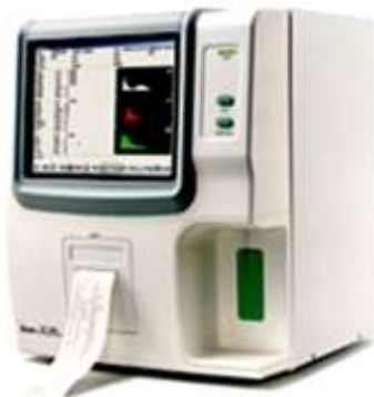
③ Automate d'hématologie ouvert 3 populations 20 paramètres 3 histogrammes de couleur Cadence : 60 tests par heure Impression directe des résultats sur papier thermique Mémoire : 50 000 résultats 3 modes de comptage : sang total, périphérique, pré-dilué Ecran LCD tactile 10,4" Dimensions : 436 x 363 x 367 mm Poids : 18 kg
