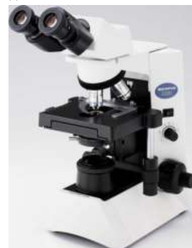
❸ Microscope Olympus CX31 Binoculaire avec inclinaison 30° Distance inter-pupillaire réglable : 48 à 75 mm Oculaire 10x – 20 mm Objectifs plans achromatiques corrigés à l'infini 4x/0.10, 10x/0.25, 40x/0.65 et 100x/1.25 immersion Condenseur d'Abbe Ouverture 1,25 Eclairage de Koehler : halogène 6 V/30 W Dimensions : 367 x 233 x 411 mm Poids : 8 kg
