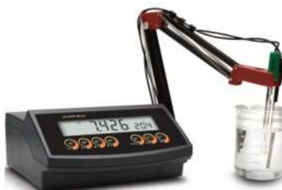
Afficheur numérique pH et T° (et mV pour EM0130) Gamme pH : -2 à 16 pH ± 0,01 pH Gamme T° : -20 à +120°C ± 0,4°C Gamme mV (pour EM0130) : ± 399,9 mV ; ± 2000 mV Étalonnage automatique en 1 ou 2 points Compensation automatique de la T° Livré avec une électrode pH corps en verre 1 m et une sonde de T° acier inoxydable 1 m Dimensions : 235 x 222 x 109 mm Poids : 1,3 kg
