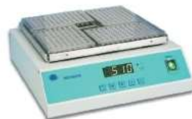
③ Agitateur orbital pour microplaque Moteur à induction Orbite : 3 mm Vitesse variable : 100 à 1 200 rpm Minuterie digitale 0 à 120 minutes Protection IP30 Surface du plateau : 220 x 220 mm Dimensions : 250 x 300 x 100 mm Poids : 7,5 kg
