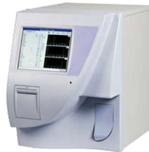
② Automate de comptage 20 paramètres (WBC, RBC, HGB, PLT, MCV et MPV) 3 histogrammes de couleur Cadence : 60 tests par heure Impression directe des résultats sur papier thermique Mémoire : 20 000 résultats Ecran LCD couleur 8" Livré avec clavier et souris Dimensions : 430 x 330 x 380 mm Poids : 23 kg
