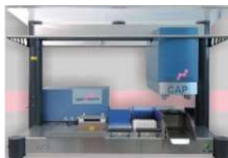
② CLART Clinical Array Processor Plateforme entièrement automatisée Utilisable pour barrettes uniquement (1 à 12 barrettes) Prise en charge des étapes de chauffage et d'agitation Tests réalisés en 3 heures Lecteur barcode
