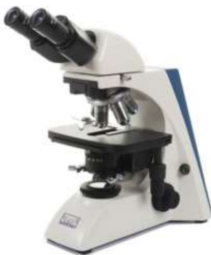
❷ Microscope éclairage Koehler Binoculaire ou trinoculaire avec caméra adaptable Inclinaison 30° et rotation sur 360° Distance inter-pupillaire réglable : 50 à 75 mm Oculaire 10x – 20 mm Objectifs achromatiques corrigés à l'infini 4x/0.10, 10x/0.25, 40x/0.65 et 100x/1.25 immersion Eclairage de Koehler : halogène 6 V/20 W ou 6 V/30 W Filtre bleu Dimensions : 390 x 200 x 395 mm
